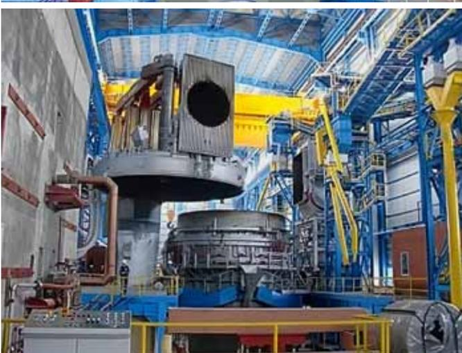
ется в том, что для нее не требуются более длинные, а для исключения поломок и более толстые электроды. Телескопический свод позволяет иметь печной объем в зависимости от количества и плотности лома и исключает потребность в более длинных электродах.
