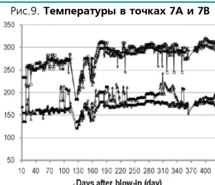
температура в точке В на 6-ом уровне постоянно составляла примерно 250°C, и температура в точке В на 7-ом уровне постоянно составляла примерно 300°C. Отметим, что точки В расположены на расстоянии примерно 1000 мм от холодной поверхности углеродистых блоков, и при этом можно легко указать, что после 400 суток
