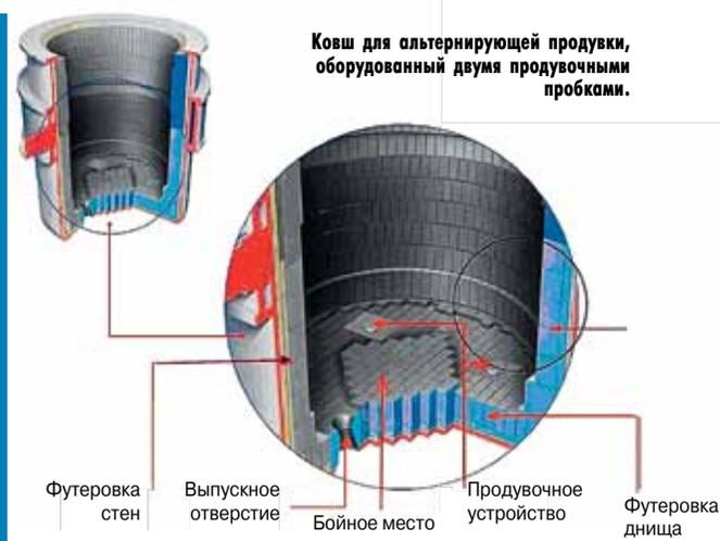
Ковш для альтернирующей продувки, оборудованный двумя продувочными пробками.
