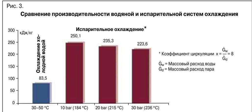
13 бар/192 °С и 28 бар/230 °С, более высокое давление обеспечивает работу паровых турбин. Почти кипящая вода поглощает энергию отходящих газов посредством испарения. Физический процесс испарения требует намного больше энергии, чем нагрев воды, например, на 20о.
